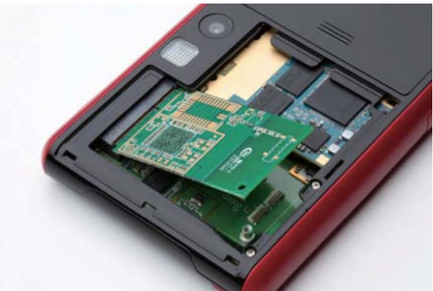
専用ハードウェアスロット
